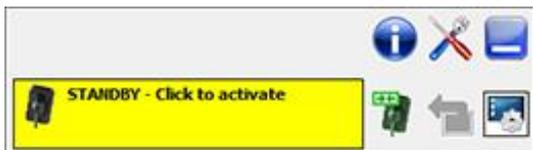
Una señal del color **amarillo** indica una situación de stand-by. Es necesario volver a activar el sensor antes de una adquisición radiográfica, por ejemplo, haciendo clic en el recuadro amarillo en la pantalla o extrayendo el sensor de su soporte.
