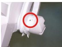
El modelo del sensor integrado en el equipo también cuenta con un testigo de estado adicional, ubicado en la interfaz del equipo. Este testigo tiene la función de señalar el estado del dispositivo y las posibles anomalías del mismo:
