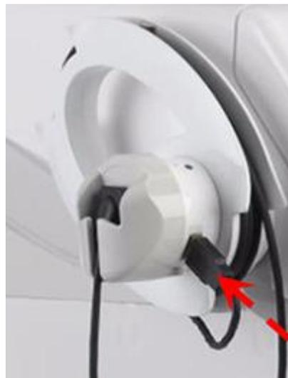
Conectar el sensor a la interfaz integrada en el equipo (sensor integrado en el equipo)
