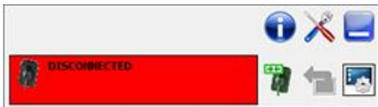
Una señal de color **rojo** indica que el sensor está desconectado del ordenador, por lo tanto, es imposible adquirir imágenes radiográficas. No realizar adquisiciones mientras el sensor se encuentre en este estado.
