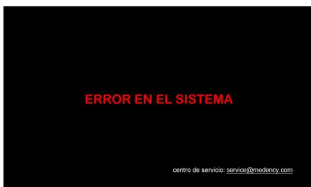
Señal generada en el caso en cual existan problemas de tipo eléctrico. En tal caso probar a apagar el sistema, esperar unos minutos y volver a encenderlo. Repetir el procedimiento de activación del manantial láser.
