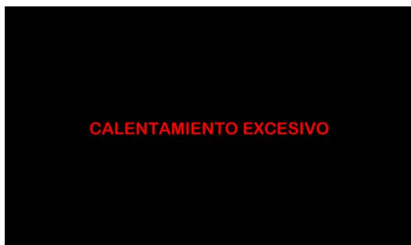
Este tipo de error aparece cuando las temperaturas del sistema dentro de la máquina están fuera del rango de trabajo. El sistema entra de forma independiente en un modo de protección, apagando todas las secciones de potencia y pasando al estado de espera.
