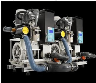
Potencia total: 3kW - 13A. Caudal máximo de aspiración: 2.800 l/min. Presión de trabajo: 210 mbar. En un sistema de aspiración Smart en paralelo, las máquinas trabajan juntas para todos los sillones, reconociéndose y regulando la velocidad según la carga de trabajo, si una falla la otra sigue.
