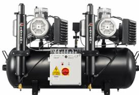
Compresor para fresadoras CAD CAM, con 2 cabezas de 3 cilindros con dos secadores de aire. Línea especial de compresores Cattani, que trabajan a presiones más altas respecto a los compresores convencionales. Dispone de 2 motores monofásicos de 230V 50 Hz y potencia total de 1,5 kW - 20.4 A.
