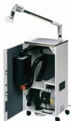
Aspiración de polvo insonorizada para un puesto de trabajo con brazo y campana. El motor esta protegido con una pastilla térmica. Tiene una potencia de 0.4KW - 3,1 A; un volumen máximo aspirado de 1250 l/min; y una presión máxima de servicio en modo continuado 1300mm H2O.
