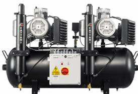
Compresor para fresadoras CAD CAM, con 2 cabezas de 3 cilindros con dos secadores de aire. Línea especial de compresores Cattani, que trabajan a presiones más altas respecto a los compresores convencionales. Dispone de 2 motores trifásicos de 400V 50 Hz y potencia total de 1,5 kW - 7.4 A.
