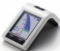
Con una precisión absoluta, sin necesidad de ajuste a cero, con calibración automática y un gran display a color, permite una localización de ápice precisa para la eliminación parcial o total de radiografías. Aviso adicional en situaciones de interés (curva pronunciada).
