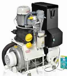
Alcanza 280mbar de presión de vacío con un motor Uni-Jet 75 2V de dos ventolas en serie y separador de amalgama. La presión elevada permite aspirar por tuberías de diámetro reducido, con una presión normal (170-200mbar) sería insuficiente. Potencia rendida: 1,5 kW - 9 A. Caudal máximo: 1.800 l/min.
