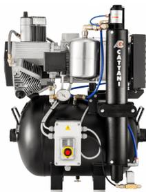
Compresor para fresadoras CAD CAM, de 3 cilindros con secador de aire. Línea especial de compresores Cattani, que trabajan a presiones más altas respecto a los compresores convencionales. Dispone de un motor monofásico 230V 50 Hz y potencia de 1,5 kW - 10.2 A.
