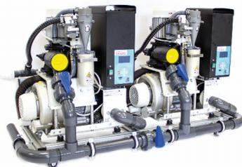
Potencia total: 4kW - 18A. Caudal máximo de aspiración: 3.400 l/min. Presión de trabajo: 280 mbar. En un sistema de aspiración Smart en paralelo, las máquinas trabajan juntas para todos los sillones, reconociéndose y regulando la velocidad según la carga de trabajo, si una falla la otra sigue.
