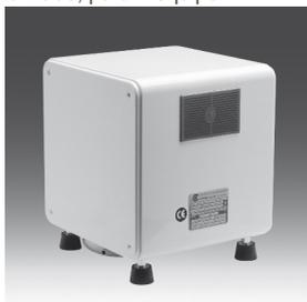
El motor está protegido con una pastilla térmica. Alimentación monofásica: 230V 50hz. Potencia: 0,4 Kw - 3,1 A. Caudal máximo: 1250 l/min. Presión de vacío: 130 mbar. Nivel sonoro: 53 dB (A).
