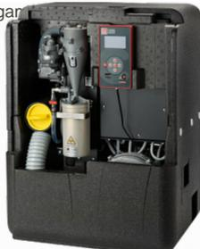
Aspiración progresiva, de 1 a 3 equipos en su versión A,. Motor mejorado, más eficiente y potente, para la mejor aspiración del mercado con el consumo más bajo. Potencia rendida: 1.1 kW - 4.8 A. Caudal máximo: 1400 l/min (1700 l/min con password). Presión máxima en servicio continuo: 210 mbar.
