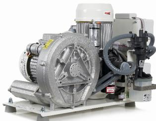
Aspiración para equipo con separador de amalgama ISO 4. Se aconseja instalación de válvula de fondo línea en el sillón (ref: 1203770). Motor protegido por pastilla térmica. Potencia: 0.42 KW - 4A. Caudal máximo: 650 l/min. Presión de trabajo: 150 mbar. Presión sonora con aire canalizado 61 dB (A).
