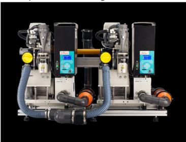
Potencia total: 3kW - 13A. Caudal máximo de aspiración: 2.800 l/min. Presión de trabajo: 210 mbar. En un sistema de aspiración Smart en paralelo, las máquinas trabajan juntas para todos los sillones, reconociéndose y regulando la velocidad según la carga de trabajo, si una falla la otra sigue.
