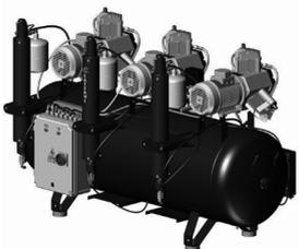
Compresor para fresadoras CAD CAM, con 3 cabezas de 3 cilindros con tres secadores de aire. Línea especial de compresores Cattani, que trabajan a presiones más altas respecto a los compresores convencionales. Dispone de 3 motores trifásicos 400V 50Hz independientes y potencia total de 4.5 kW - 11.1 A.
